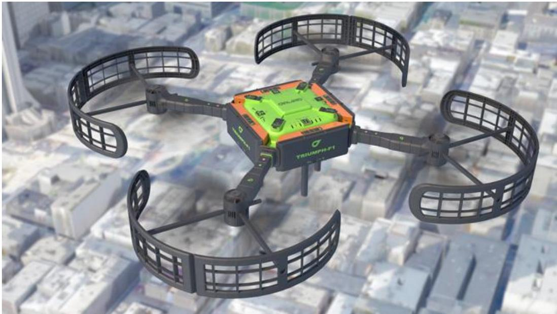
**TRIUMPH-F1:** Aeronave no tripulada (dron multirrotor de 8 hélices) para fines cartográficos no necesita un entrenamiento de vuelo, solo se debe seleccionar el programa y hacer clic en "Fly"
