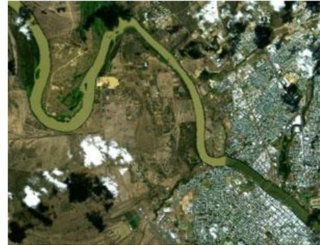
A diferencia del sensor anterior, el **PRISM** capta imágenes pancromáticas y se destaca por la resolución espacial que estas poseen de 2.5 metros y porque cada escena contiene 3 perspectivas (nadir, hacia atrás y hacia delante), con una superficie común de 35\*35 Km<sup>2</sup>, de manera que permite hacer estereoscopia y generar modelos digitales de elevación de alta precisión.
