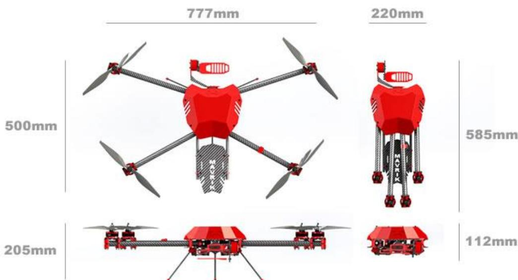
Figura 4: Dimensiones del SteadiDrone UAV.
