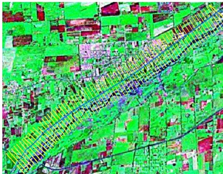
Fig. N° 3: Error de calce entre los datos CAD y la ubicación real del cauce.
