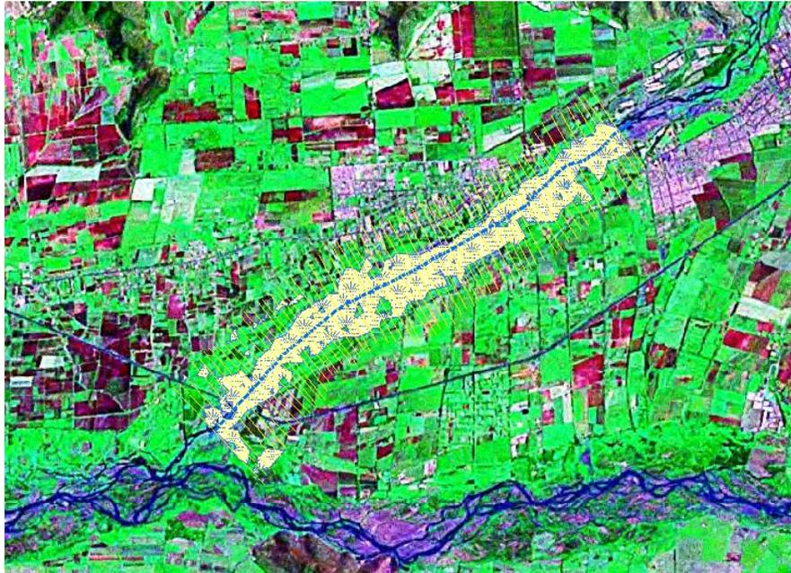
Fig. N° 6: Superposición del área de inundación (T = 100) y la imagen con la cobertura del suelo.
