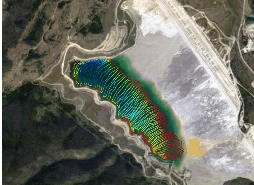
Figura 5. Levantamiento completado con el Z-Boat en Noviembre de 2012 utilizando una ecosonda Airmar DT800 con un GNSS Trimble R8.
