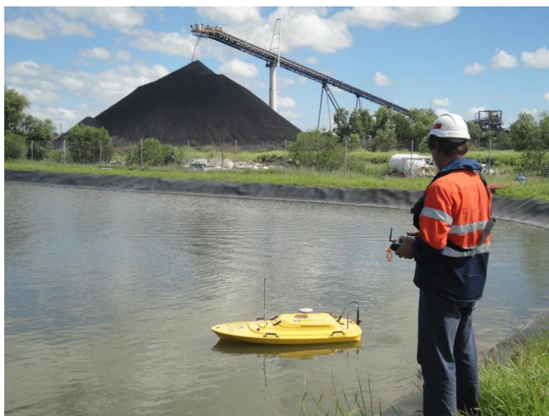
Figura 1. Z-Boat 1800 midiendo acumulación de sedimentos en Queensland, Australia.
