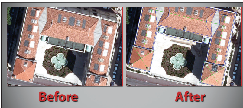
La inclinación típica del edificio (izquierda) puede esconder los detalles en las imágenes aéreas. Con Verdadero Orto (derecha), no hay inclinación del edificio o áreas ocultas; únicamente una vista real perpendicular del mosaico completo.
